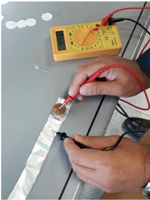
Alla fine ecco il test! La nostra pila produce all'incirca 4,50V, niente male!
